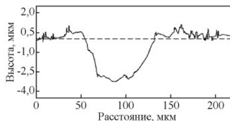
Рис.9. Данные профилометрии поверхности стали 08Х18Н10Т после облучения твердотельным NdYAG-лазером ( N=30 , W=5,5 Дж/см 2 ).
