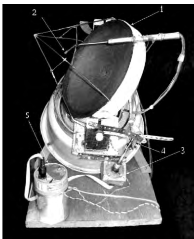
Рис. 3.4. Телескоп Т3 ( Т4) 1 – стальное зеркало с параболической поверхностью, 2 – счетчик Гейгера (Т3) с закрепленным на нем бета источником (Т4), 3 – шаговый двигатель, 4 – механизм поворота вокруг оси склонений, 5 – устройство управления шаговым двигателем
