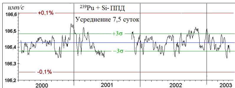
Рис.1.16. Результаты продолжительных измерений активности альфа источника ^{239}\text{Pu} полупроводниковым детектором [187,189,224]
