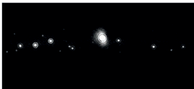
Рис. 1. Характерный вид поля зрения ультрамикроскопа при наблюдении наночастиц ( R=55 нм) в воде
