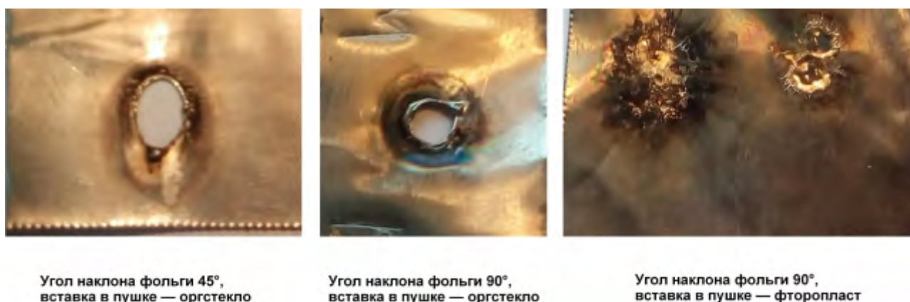
Рис. 9. Прожиг никелевой фольги гетерогенной плазменной струей в дозвуковом режиме при P_{ст} = 0,5 Бар в аргоне
