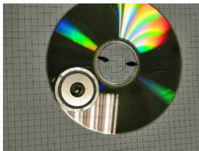
Рис.2. Фото СД диска с неодимовым магнитом.
