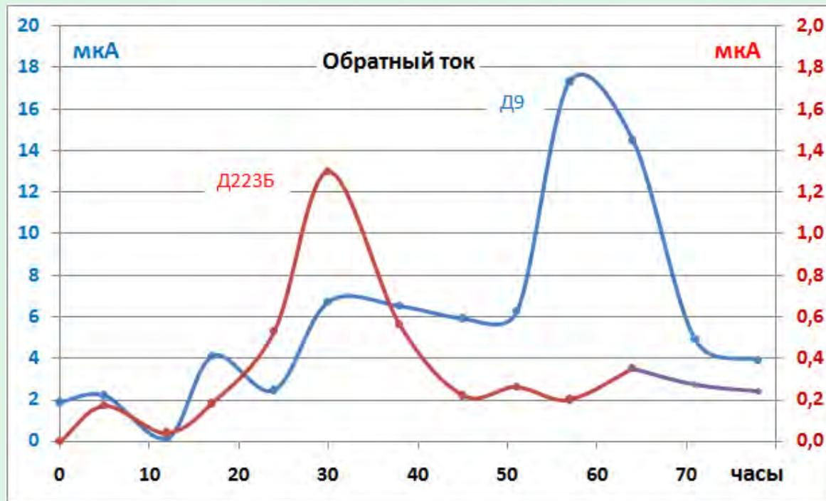
*Изменение обратного тока германиевого диода Д9 и кремниевого диода Д223Б при напряжении 7,4 В, расположенных около работающего реактора. Прямое падение напряжения диодов меняется незначительно.*
