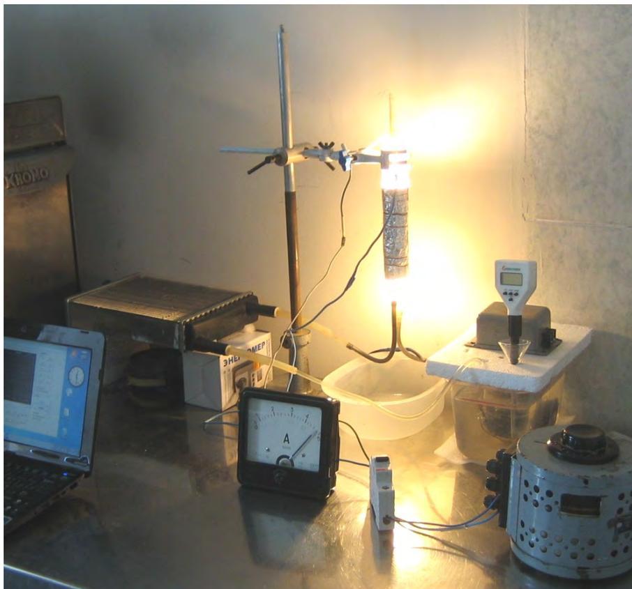
Галогенная лампа накаливания (220В, 300Вт) находится в кварцевой трубе, через которую прокачивается дистиллированная вода. Вода охлаждается, проходя через теплообменник.
