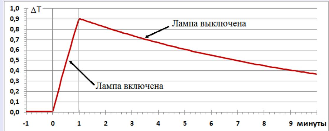
Изменение температуры в процессе включения и выключения лампы
