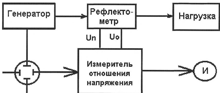
Рис. 3. Схема панорамного измерителя
